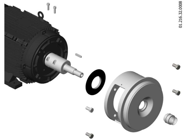
10. Afloje los tornillos Allen (51A) que fijan el eje (05) al motor (93). Si no sé puede sacar el eje (05) puede introducir un tornillo en el primer agujero de fijación del eje para ayudar a sacarlo.
